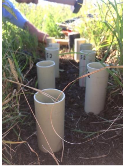
Figure 16 Intact core sampling in Los Puestos
